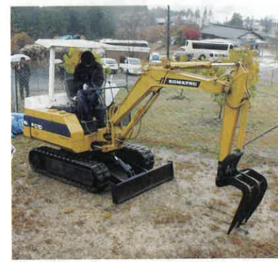
凍害対策の「株ゆるめ処理」で使うフォーク型バケット
